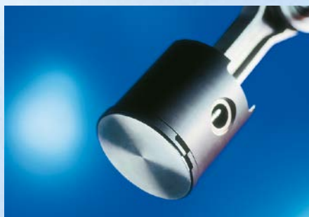
Segments de piston et éléments de guidage Pour les compresseurs fonctionnant sans huile. Coefficient de frottement extrêmement faible combiné avec du métal – même sans lubrification.
