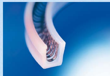
Joints en PTFE avec ressort Pour l'étanchéité des pistons et des tiges effectuant des mouvements de va-et-vient et pour les applications rotatives et basculantes. Excellente résistance chimique aux milieux agressifs.
